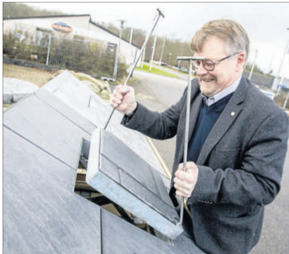
Sådan løftes den nye type brønddæksler op, viser Jesper Walter-Rasmussen.
